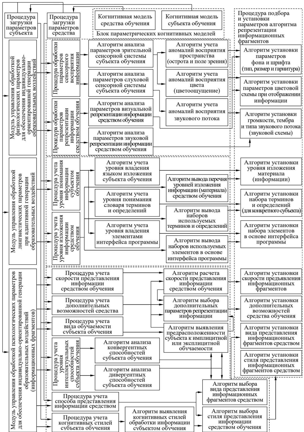
Рис. 3. Структура процессора адаптивной репрезентации информационных фрагментов
